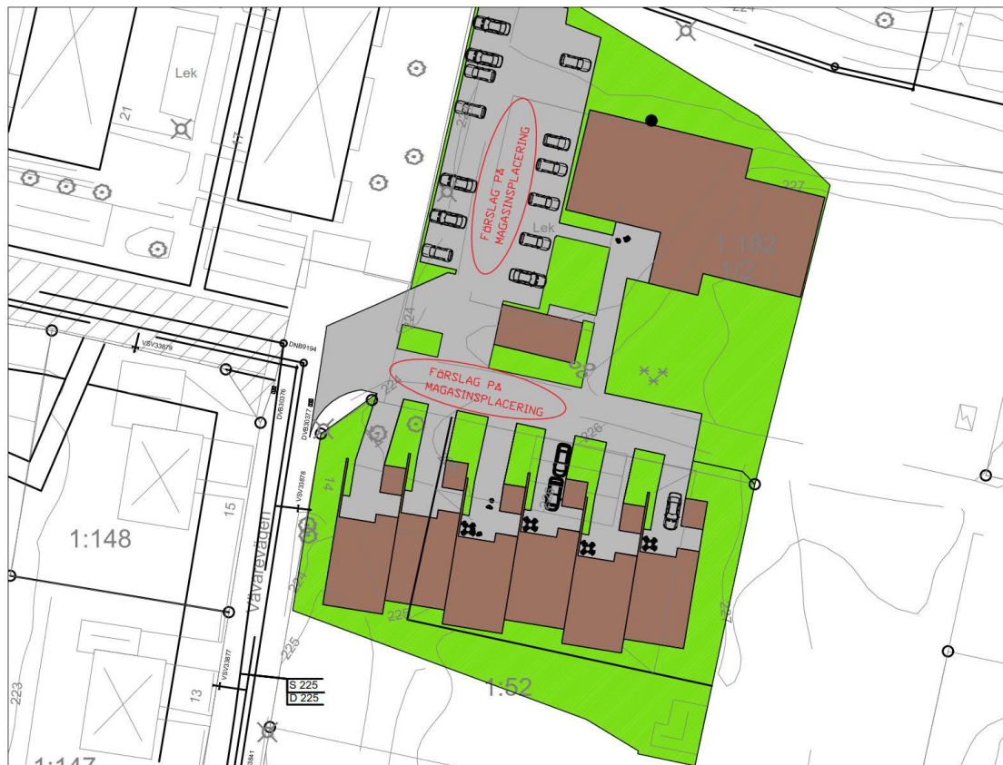
Figur.3 Läge för två fördröjandedagvattenmagasin
