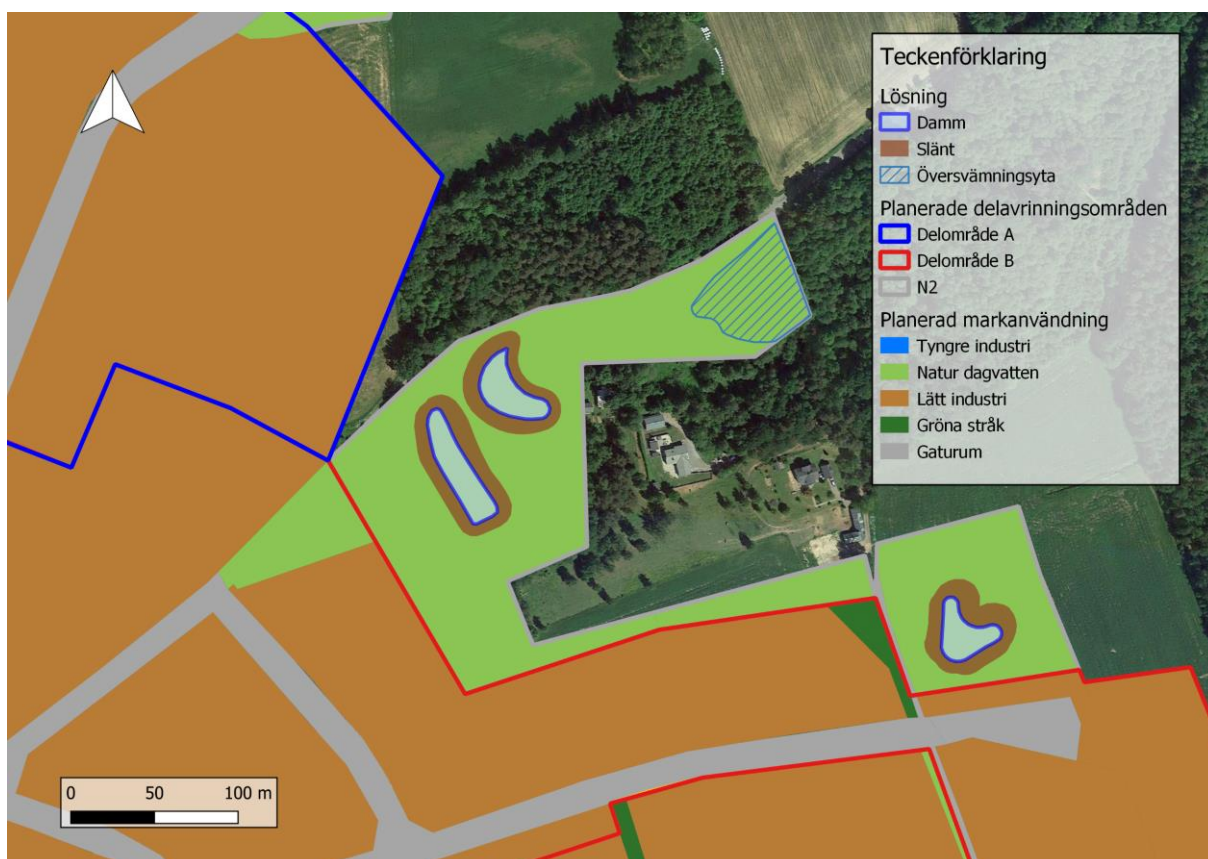
Figur 17. Skiss över dammarna (slänter inkluderade) i delområde B på Hedenstorp Östra. Delområdet N2 representerar naturområde med planerade dagvattenlösningar.
