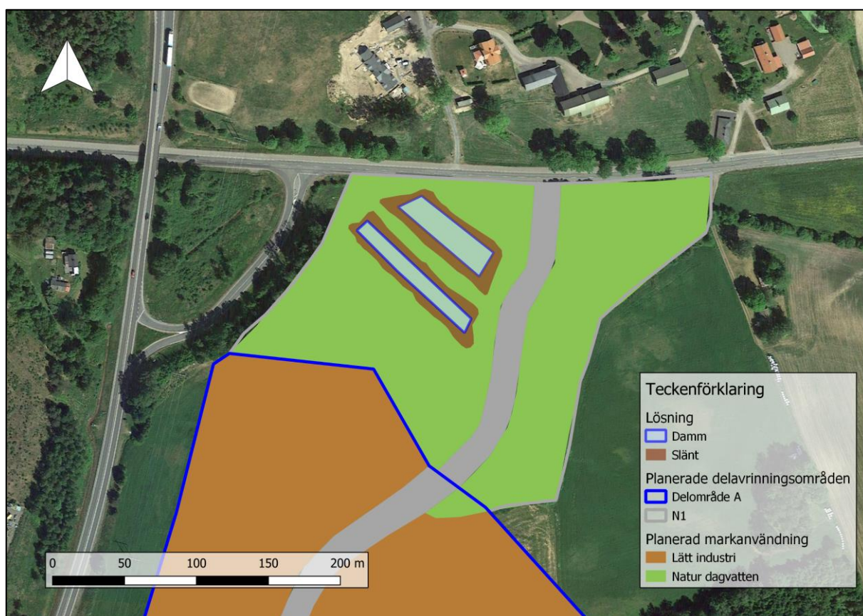
Figur 16. Skiss över dammarna (inklusive slänter) i delområde A på Hedenstorp Östra. Delområde N1 representerar naturområde med planerade dagvattenlösningar.
