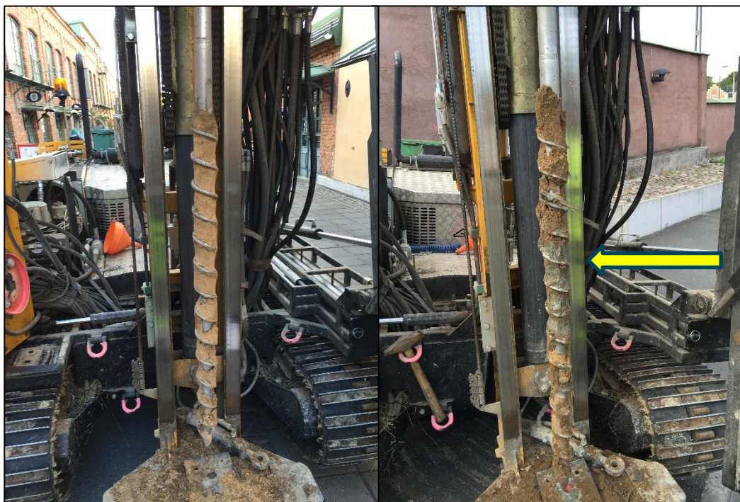
Figur 3. T.v. isälvssand som har dokumenterats under fyllnadsmaterialet i samtliga provtagningspunkter. T.h. prov BH5 3,0-3,3 m.u.my. Förhöjda VOC-halter och trärester mellan 3,0-3,3 m.u.my (se pil).
