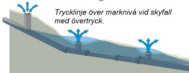
Figur 1-2. De två bilderna till vänster illustrerar skillnaden mellan ett regn som anläggningen har dimensionerats för och ett skyfall där anläggningens kapacitet överskrids. Bilden överst till höger visar hur ett ledningsnät som fungerar väl uppströms, blir överbelastat längre ned i systemet vilket leder till att vatten strömmar bakvägen, ut från brunnar, och förvärrar situationen för dessa lågpunkter. Bilden nere till höger visar situationen där nivåskillnader i ledningsnätet, tillsammans med att kapaciteten i systemet överskrids, leder till att vatten trycks ut ur brunnar (trycklinje över marknivå). (MSB, 2017).
