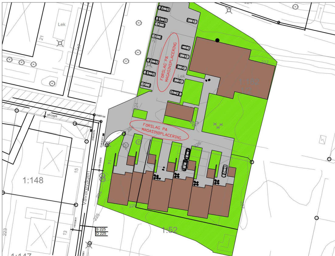
Figur.3 Läge för två fördröjandedagvattenmagasin
