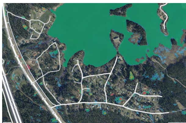
Figur 27 Lovsjöområdet vid 90 mm nederbörd (100 års-regn med klimatfaktor 1,4) och ingen markinfiltration medräknad. De röda områdena visar ett vattendjup över 50 cm, det gula är mellan 30-50 cm och det gröna är mellan 10-30 cm.
