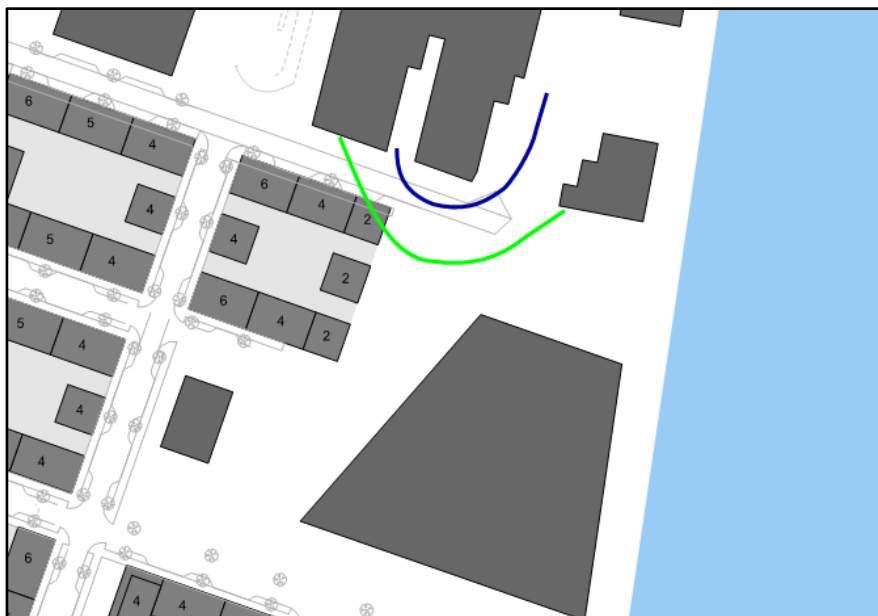
Figur 14. Gräns för 15 kW/m 2 infallande strålning (blå) och 2,5 kW/m 2 (grönt) vid brand i papperslager.
